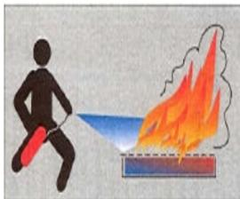
**Nello spegnimento di un liquido infiammabile** l'azione estinguente va indirizzata verso il focolaio con direzionalità e distanza di erogazione tale che l'effetto dinamico della scarica trascini la direzione delle fiamme tagliandone l'afflusso dell'ossigeno. Occorre fare molta attenzione a non colpire direttamente e violentemente il pelo libero per il possibile sconvolgimento e spargimento del combustibile incendiato.
